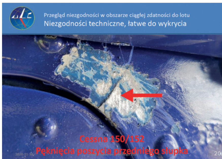
Fot. 5. Pęknięcie poszycia (okolice węzła przenoszące obciążenia)
