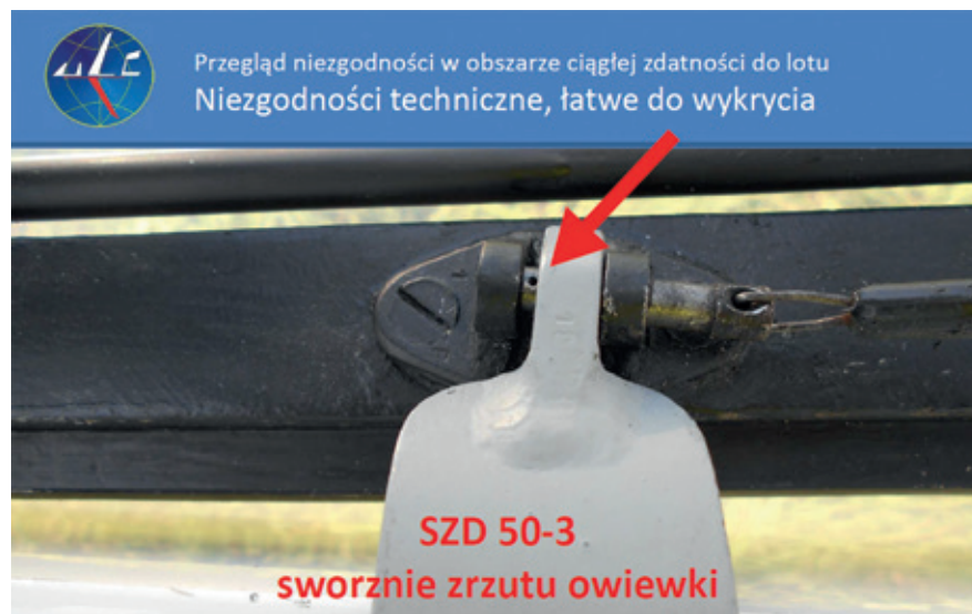
Fot. 4. Brak zabezpieczenia sworznia przed wysunięciem
